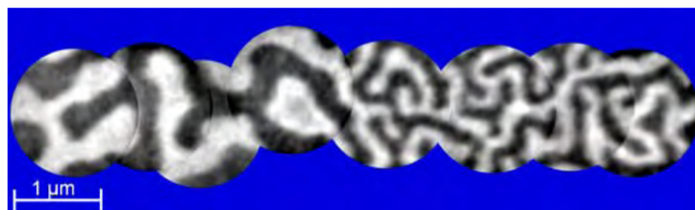
Abb. 2: Magnetische Domänenstruktur eines Co/Pt-Films unter dem Einfluss einer von links nach rechts ansteigenden Eisenbedeckung.
