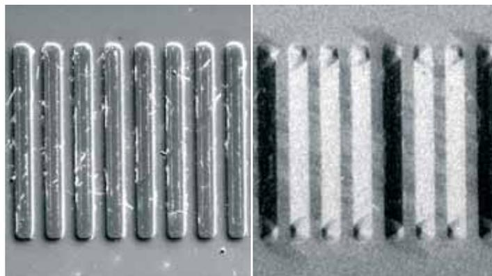
Abb. 1: SEM- und SEMPA-Aufnahme von Permalloy-Strukturen auf  $\text{SiO}_2$ . Das linke Bild entspricht einer konventionellen Rasterelektronenmikroskopie-Aufnahme. Das rechte Bild zeigt die Magnetisierungsverteilung des gleichen Probenausschnitts. Weiss/schwarz bedeutet, dass die Magnetisierung nach oben/unten zeigt. Die Breite der Strukturen beträgt  $2 \mu\text{m}$ .
