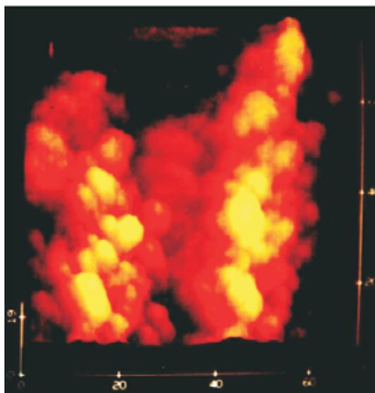
Abb. 1: Primärteilchen mit einem Durchmesser von ca. 10 nm.
