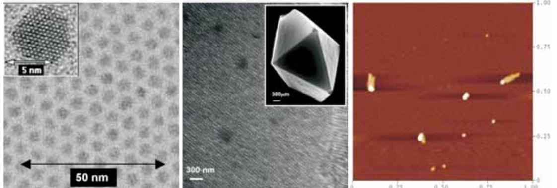
**Links** (Abb. 1): Elektronenmikroskopische Aufnahme von CdSe-Nanopartikeln. Im Einsatz erkennt man bei höherer Vergrößerung die Kristallnetzebenen. **Mitte** (Abb. 3): Kristall aus  $\text{CoPt}_3$ -Nanopartikeln (kleines Bild). Die einzelnen Teilchen sind als kleine Kugeln zu erkennen und bilden facettierte Oberflächen aus (großes Bild). **Rechts** (Abb. 4): Rasterkraftmikroskopische Aufnahme von CdTe-Nanopartikeln, an deren Oberfläche kurze DNA-Stränge chemisch angeknüpft wurden.
