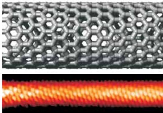
Abb. 2: Modell und atomar aufgelöste Rastertunnelmikroskopie-Abbildung einer Kohlenstoff-Nanoröhre.
