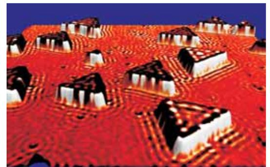
Abb. 3: Kobaltinseln mit einer Höhe von zwei atomaren Lagen auf einer Kupferoberfläche. Die wellenartigen Muster sind Interferenzen der Elektronenwellen im Kupfer, welche an den Kobaltinseln und anderen Defekten im Kristall gestreut werden.
