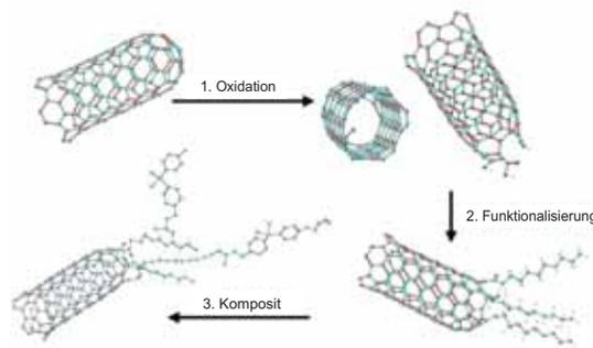
Abb. 1: Beispiel für eine Oberflächenmodifikation. Durch eine Oxidation werden Carboxylgruppen auf der Oberfläche gebildet (Schritt 1). Eine Reaktion mit einer Aminkomponente führt zu einer Funktionalisierung (Schritt 2). Die Epoxidharzmatrix wird über die Aminofunktionen an die Kohlenstoff-Nanoröhrchen angebinden (Schritt 3).
