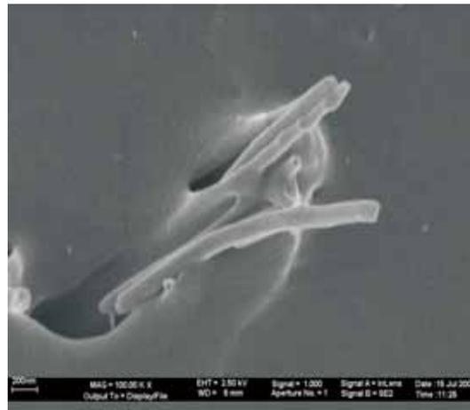
Abb. 2: Kohlenstoffnanofasern, einpolymerisiert in syndiotaktisches Polypropylen.
