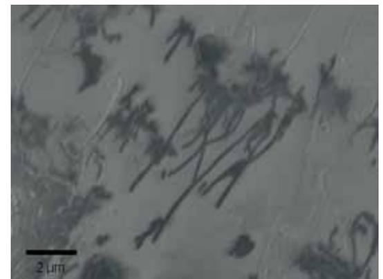
Abb. 4: Rasterelektronenmikroskopische Aufnahme eines Schnitts durch ein Nanokomposit. Die Kohlenstoff-Nanoröhrchen bilden elektrisch leitfähige Pfade im Polymer.
