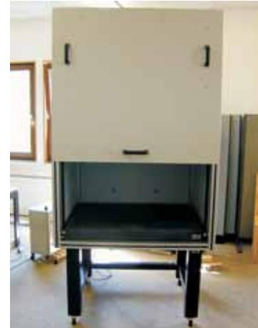
Abb. 3: Lichtdichter Faradaykäfig mit integrierter Schwingungsdämpfung
