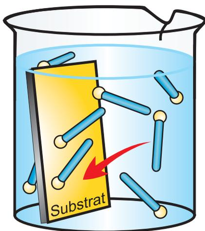
Abb. 1: Die spontane Bildung einer selbstordnenden Monoschicht
