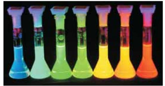
Abb. 2: Fluoreszenz von CdSe-Nanopartikellösungen. Die mittlere Größe der Partikel nimmt von 2.5 nm (blau) bis 6 nm (rot) kontinuierlich zu.
