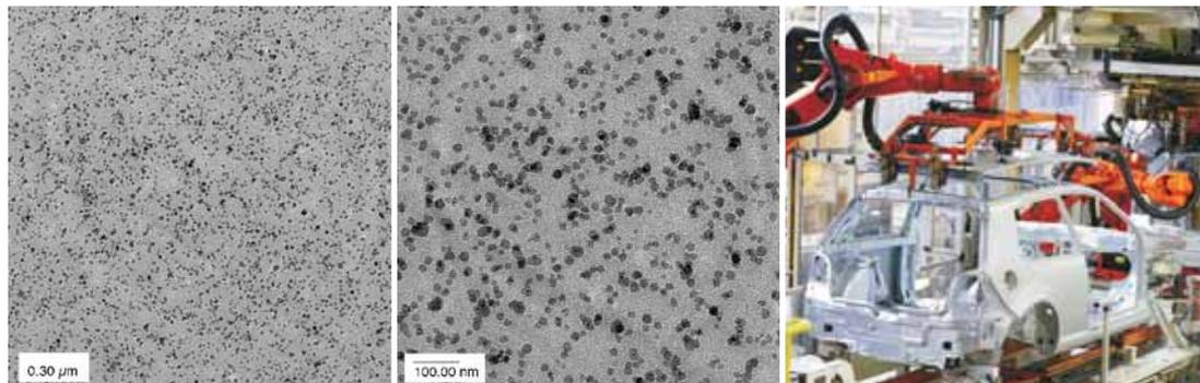
Abb. 1: Transmissionselektronenmikroskop-Aufnahmen einer gehärteten Probe Nano-pox<sup>®</sup> mit 5 %  $\text{SiO}_2$ -Nanopartikeln (© hanse chemie AG).
