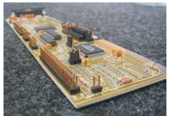
Abb. 2: Leiterplatte, welche mit einer auf organischen Metallen basierenden Beschichtung versehen ist und in einem Tauchprozess verzinkt wurde.
