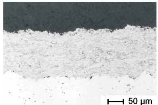
Abb. 3: Querschliff einer Schicht, die durch thermisches Spritzen von nanostrukturierten Verbundwerkstoffen hergestellt wurde.
