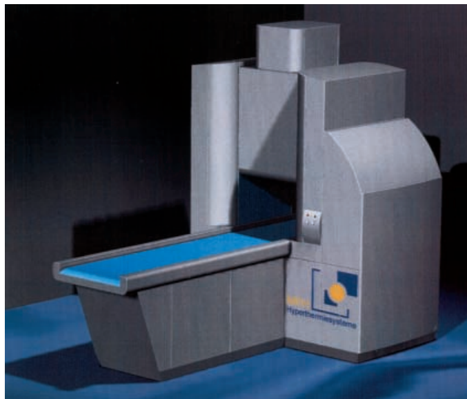
Abb. 2 ▲ Erstes klinisches Magnetwechselfeld-Therapiesystem für die Magnetflüssigkeits-Hyperthermie (MFH ® -300F), das zurzeit am Universitätsklinikum Charité, Klinik für Strahlenheilkunde aufgebaut worden ist. Das Gerät erzeugt ein homogenes magnetisches Wechselfeld mit einer Frequenz von 100 kHz und einer Feldstärke bis 15 kA/m. Gezielt in einem Tumor deponierte oder in Tumorzellen angereicherte eisenoxidhaltige Nanopartikel, die speziell für diese Anwendung entwickelt wurden, können durch das magnetische Wechselfeld auf bis zu 47°C aufgeheizt werden, während unbeladenes Gewebe sich kaum erwärmt. Die Temperaturmessung erfolgt mittels fluorooptischer Messsonden. Die Gleichgewichtstemperatur in der Zielregion wird über die Magnetfeldstärke reguliert. (Abdruck mit freundlicher Genehmigung der MFH Hyperthermiesysteme GmbH, Berlin)
