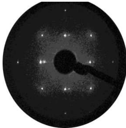
Abbildung 11: Beugungsbild von niederenergetischen Elektronen (220eV) an einer Cu(1113)-Oberfläche. Die Stufenkanten verlaufen in vertikaler Richtung.
